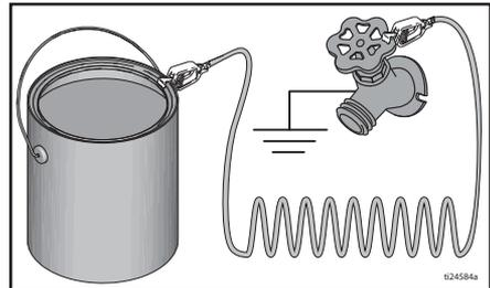
**Para mantener la continuidad de la conexión a tierra cuando se lava el pulverizador o se libera la presión:** mantenga la parte metálica de la pistola de pulverización firmemente contra el costado de un bidón metálico conectado a tierra y dispere la pistola.
