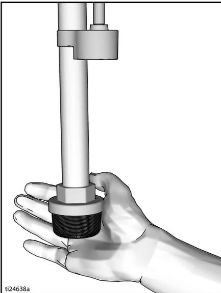
7. Llene la tuerca de la empaquetadura del cuello con TSL para evitar el desgaste prematuro de la empaquetadura. Haga esto a diario o cada vez que pulverice.
