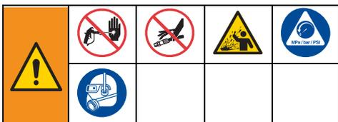
Este equipo seguirá presurizado hasta que se descomprima manualmente la presión. Para evitar lesiones graves por fluido presurizado, como la inyección en la piel, salpicaduras de fluido y las ocasionadas por piezas en movimiento, siga el Procedimiento de descompresión cuando deje de pulverizar y antes de limpiar, revisar o realizar el mantenimiento del equipo.
