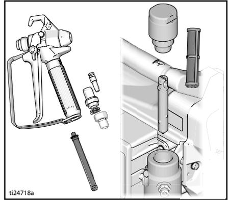
14. Si se utiliza agua para el lavado, vuelva a lavar con alcohol mineral o con Protección para bombas y deje este recubrimiento protector en el pulverizador para ayudar a evitar la congelación o la corrosión.
