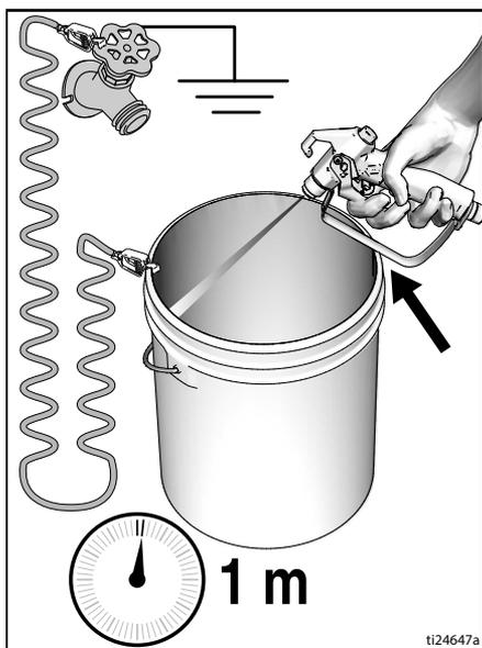
8. Apunte la pistola hacia el bidón de pintura y dispárela durante 20 segundos. Suelte el gatillo y permita que el pulverizador acumule presión. Coloque el seguro del gatillo.
