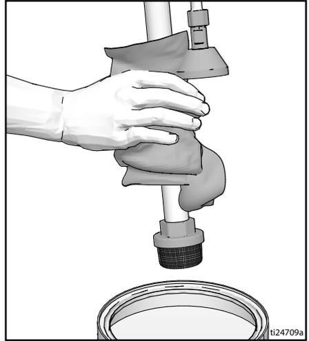
4. Coloque la admisión de fluido en el fluido de lavado. Utilice agua para las pinturas a base de agua y alcohol mineral para pinturas con base oleosa. Coloque el tubo de drenaje en un cubo de desecho.
